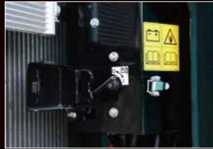
电源总开关 在长时间不运行的情况下防止电瓶劣化，并且能够在维护电力系统时安全地作业。
